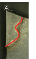
チップが取れなかった刃・刃に食い込むようにチップが埋め込まれている・刃とチップの接触面が多い
